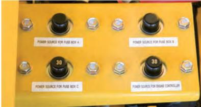
يتم استخدام قاطع الدائرة في الدوائر الكهربائية المهمة التي يجب استعدادتها في وقت قصير عند حدوث عطل في النظام الكهربائي.
